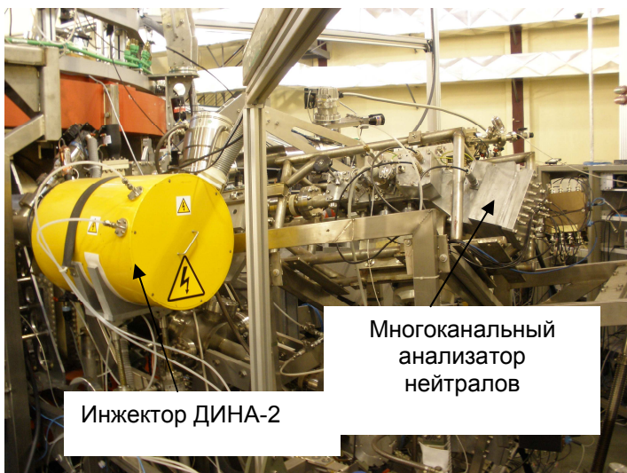
Рис.4.25. Диагностический инжектор и анализатор нейтралов в составе стелларатора TJ-II (Испания, Мадрид)
